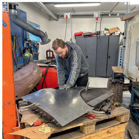
Opiskelijat valmistavat kylkipellit perinteisillä menetelmillä – jigien vasten sovittaen muodot saadaan tismalleen oikeiksi.
