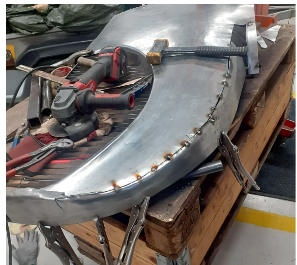
Opiskelijat valmistavat kylkipellit perinteisillä menetelmillä – jigien vasten sovittaen muodot saadaan tismalleen oikeiksi.
